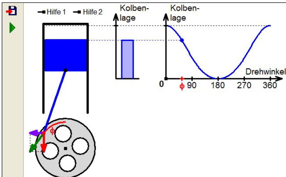
Abb. 78: DynaGeoX-Applet zum Kolbenmotor
