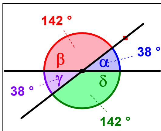
**Abb. 47:** Winkel an einer Geradenkreuzung
