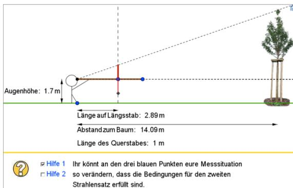
Abb. 11: Messen mit dem Jakobsstab vorbereiten
