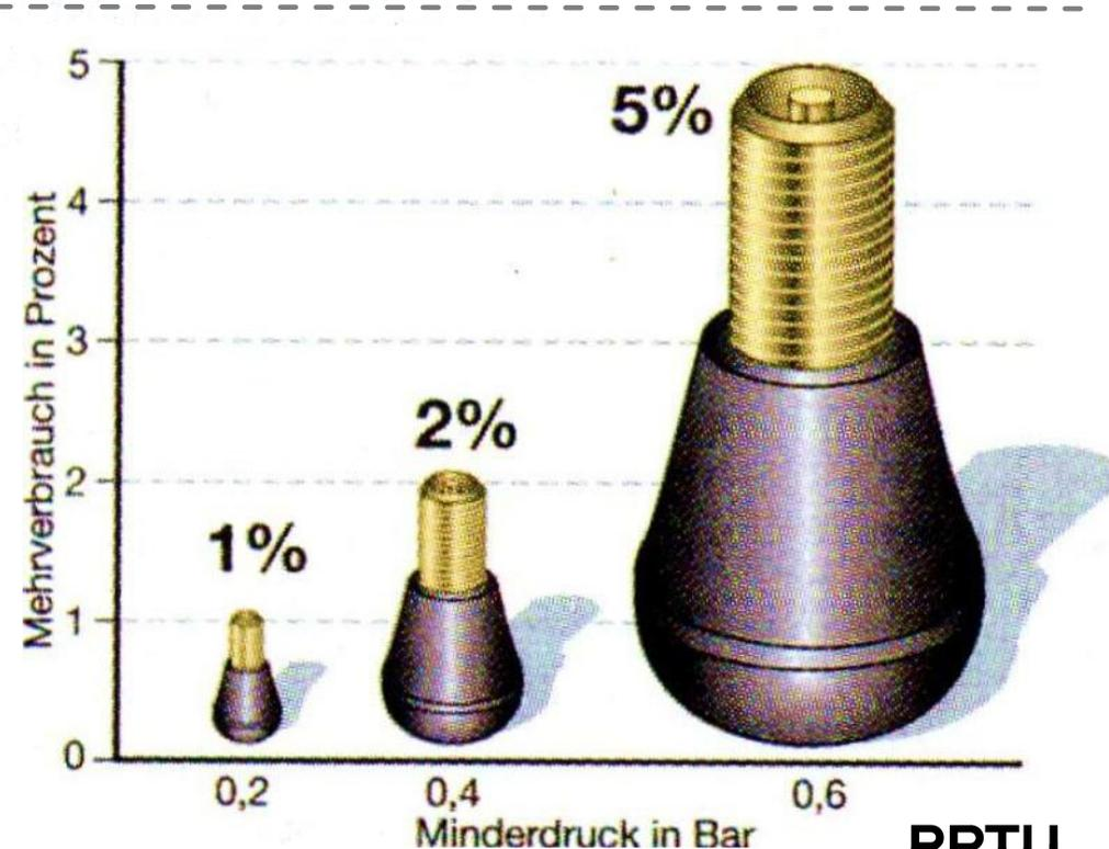
Die Bedeutung des richtigen Reifendrucks wird oft unterschätzt. Schon bei einem Minderdruck von 0,2 bar erhöht sich der Rollwiderstand und sorgt für einen Mehrverbrauch von etwa einem Prozent. Ist der Druck noch geringer, steigt der Spritkonsum weiter.
