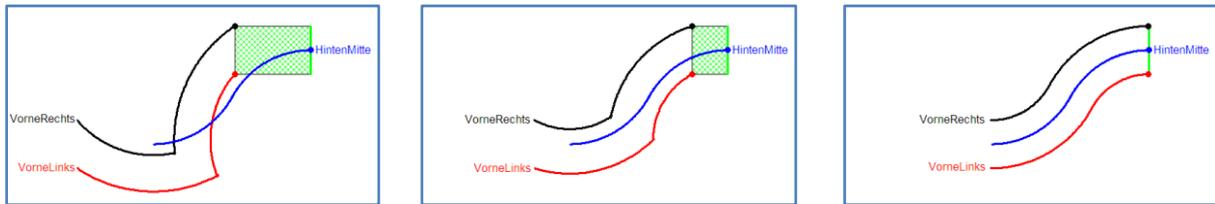
Abb. 12: Variation des Abstandes „Front↔Hinterachse“ – Analoges ergibt sich für den Abstand „Hinterachse↔Heck“
