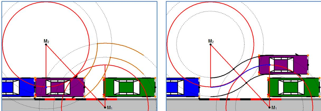
Abb. 13: Hilfslinien zur Verdeutlichung der Entstehung der „Knicke“ in den Ortslinien
