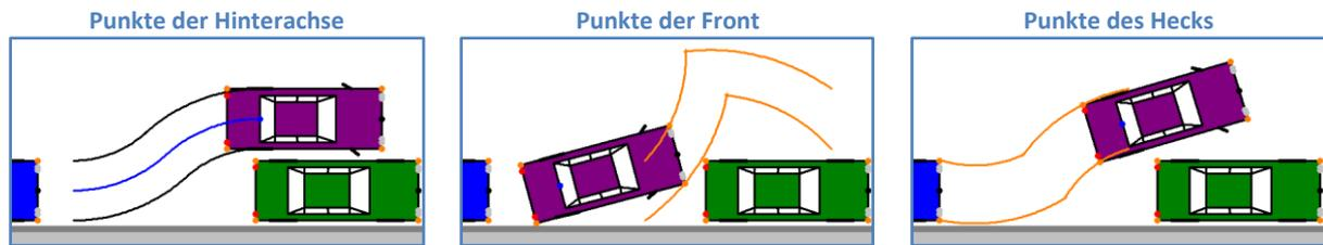
Abb. 9: Ortslinien für verschiedene Punkte des Autos beim parallel Einparken nach Fahrschulregel
