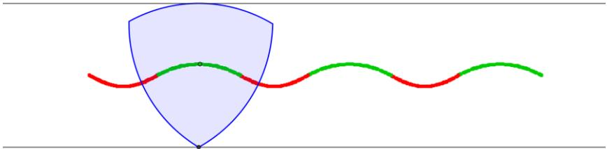
**Abb. 10a:** Bahnkurve des Mittelpunkts des Reuleaux-Dreiecks beim Abrollen auf einer Geraden
