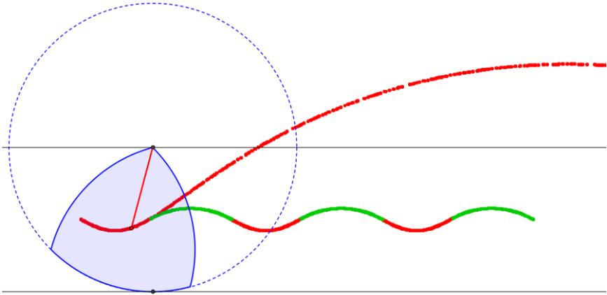
**Abb. 10c:** Teilkurven: Beim Abrollen auf einer „Seite“ des Reuleaux-Dreiecks entstehen Zyklidenabschnitte
