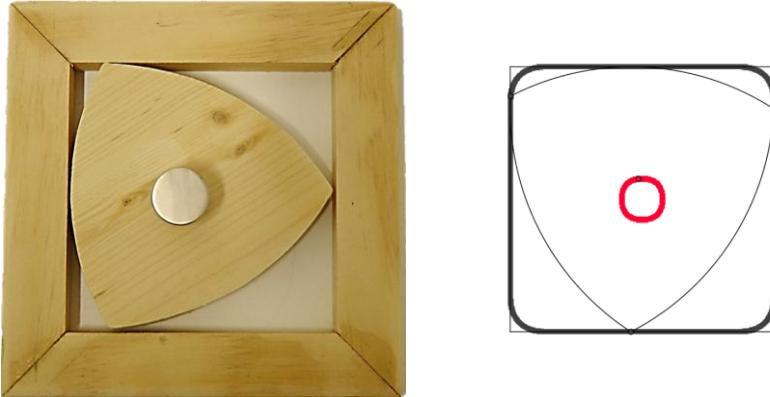
**Abb. 18:** „Quadratische“ Löcher bohren
