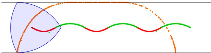
**Abb. 10d:** Bahnkurve eines Eckpunkts des Reuleaux-Dreiecks
