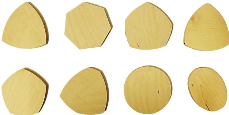
Abb. 3: Lassen sich diese Hölzer als Unterlegrollen verwenden?
